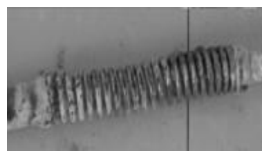
图 3 锈蚀的弹性销
